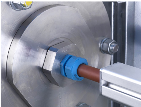
Dichtheitsprüfung / Sealing test
