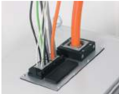
Useamman kaapelin läpivienti. Mukana valmiskaapeleita liittimiseen ja perusläpimenoa ilman liittimiä olevilla kaapeleilla. Moduulilaipan asennusaukko 314x144 mm.
