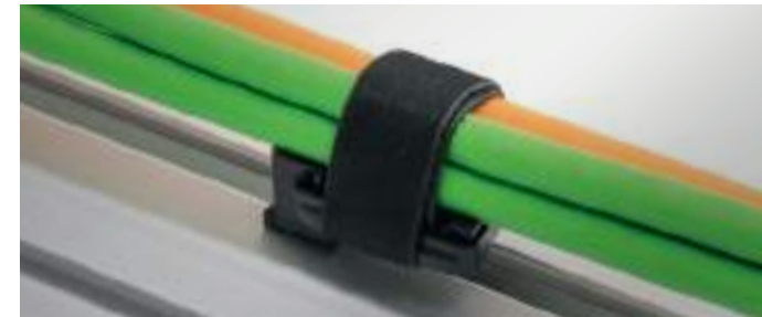
Kiinnikkeet tarranippusiteille useita eri kiinnitystapoja: ruuvikiinnitys, plug-in kiinnitys, saatavilla useille eri profiilikiskoille yhteensopivia versioita, yhteensopiva KLB tarranauhojen ja KLKB tarrakaapelisiteiden kanssa.
