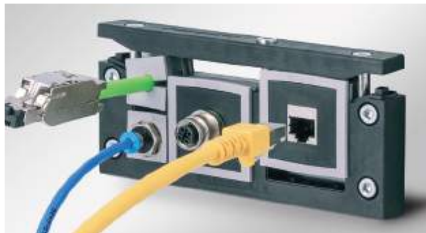
USB (tai RJ45, HDMI) liittimet asennettuna tiivisteosaan. Verkkoliittimet painetaan paikalleen sisäpuolelta
