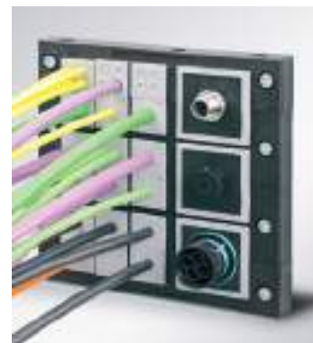
KEL 24/21-2 MT kalustettuna 3 x AT-M tiivisteosilla, joihin on kierretty kiinni M16 liitin, M12 anturiliitin ja yhdistelmäliitin
