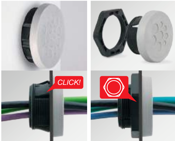
Asennustapa 1: "Snap-in", painamalla asennusaukkoon Seinävähvahvuuksille 1–2,5 mm
