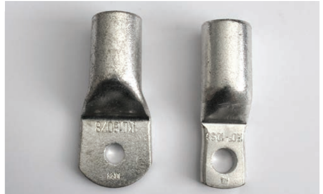
Kuva 7: R- ja SG-kaapelikengät (huomaa SG:n kapea lapa)
