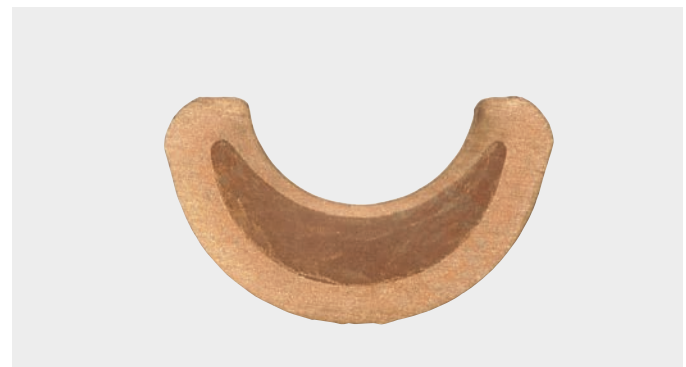
Kuva 10: Poikkileikkaus - tuurnapuristus, luokan 6 johdin F-kaapelikengässä
