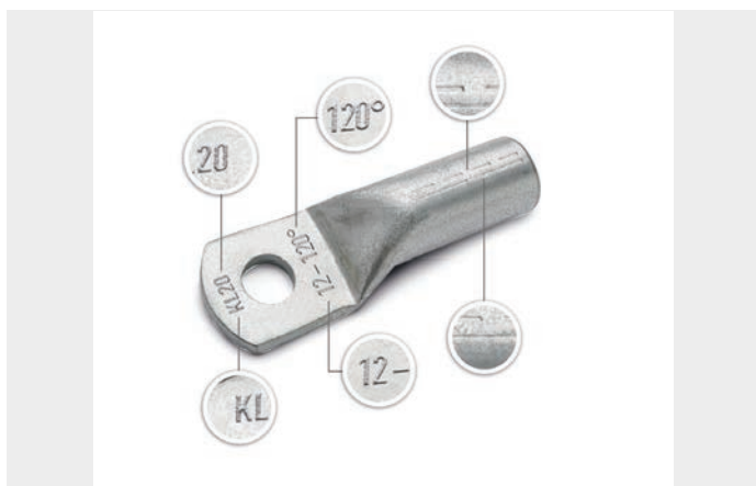
Kuva 6: DIN -kaapelikengä merkintöineen
