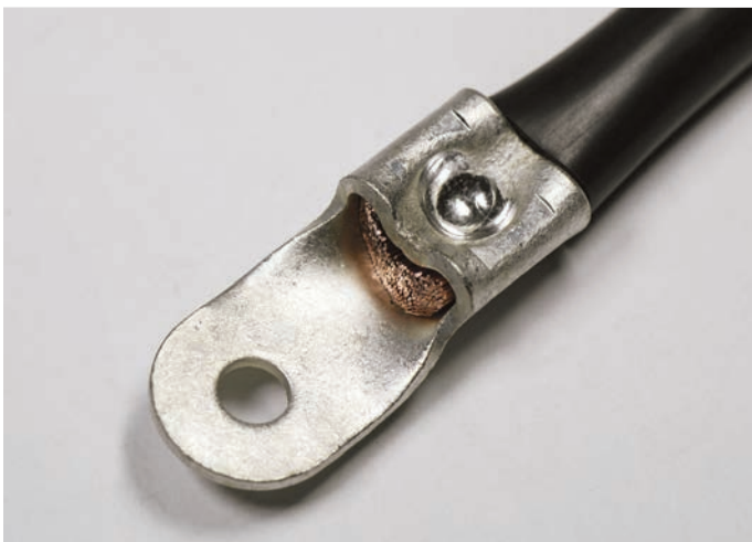
13: Levykaapelikengä, tuurnapuristettu Q22 leuoilla
