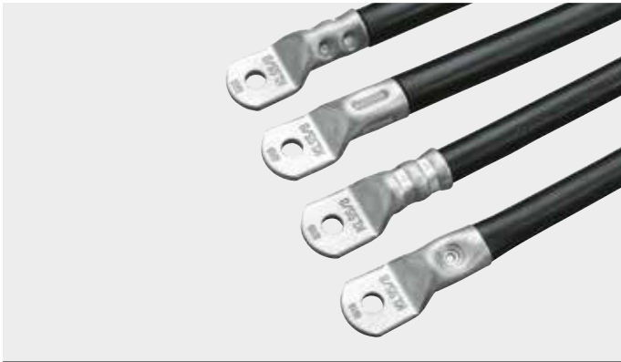
Kuva 1: Eri puristustavoilla puristettuja R-kaapelikenkiä
