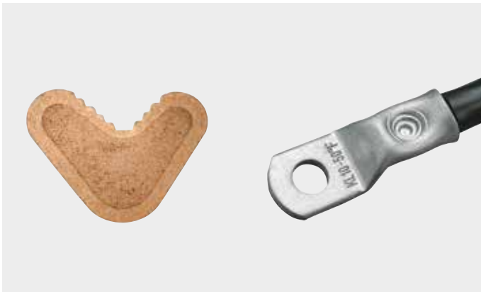
Kuva 6: Tuurnapuristettu Cu-kenkä, luokka 5 (poikkileikkaus) ja tuurnapuristettu R-kaapelikenkä
