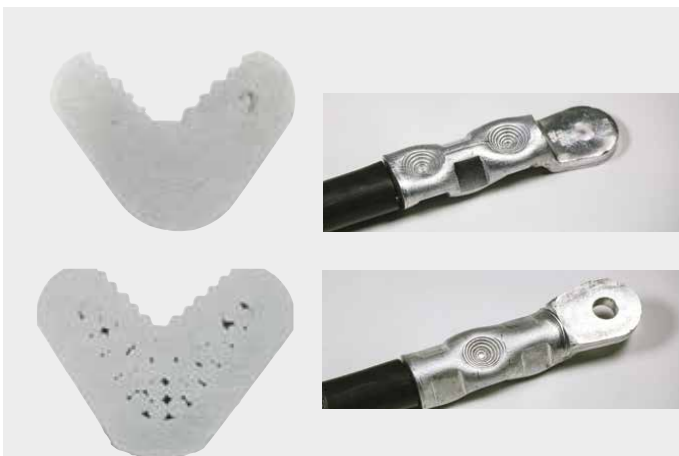
Kuva 7: Tuurnapuristetut Al-kengät, luokat 1 ja 2 (poikkileikkaukset) sekä tuurnapuristettu Al-kaapelikenkä ylä- ja alapuolelta
