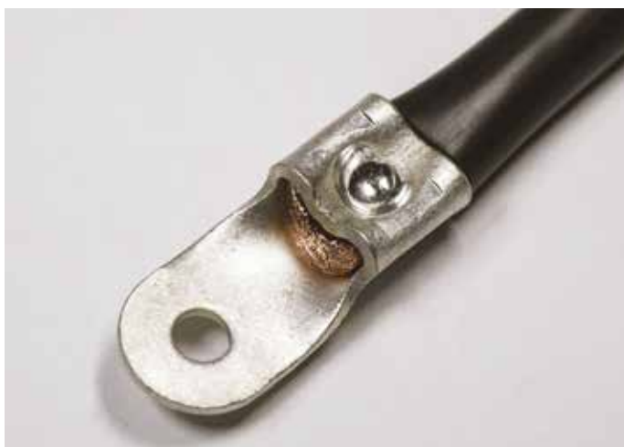
13: Levykaapelikenkä, tuurnapuristettu Q22 leuoilla
