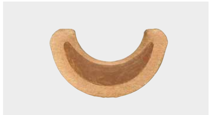
Kuva 10: Poikkileikkaus - tuurnapuristus, luokan 6 johdin F-kaapelikengässä
