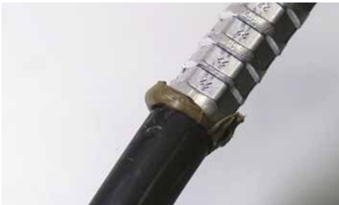
Kuva 2: Alumiinikaapelikengä, josta ylimääräinen kontaktirasva on puristamisen yhteydessä työntynyt ulos
