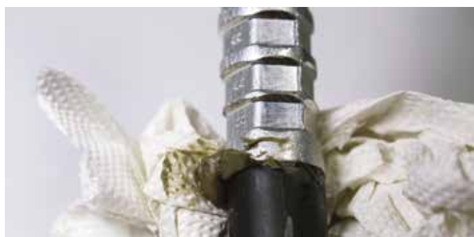
Kuva 8: 1. Poista eriste, 2. Puhdista johdin, 3. Aseta johdin, 4. Purista (tässä kuusioapuristus), 5. Pyyhi kontaktirasva pois
