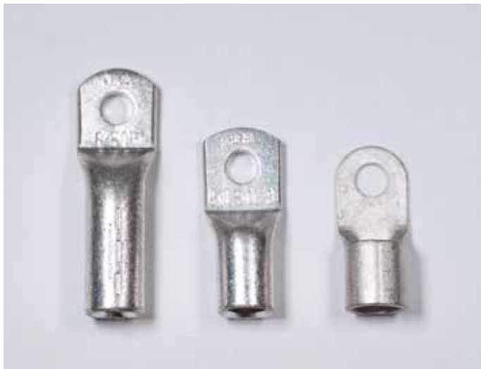
Kuva 2: Putkikaapelikengä DIN46235, putkikaapelikengä Standard-type ja levykaapelikengä DIN 46234
