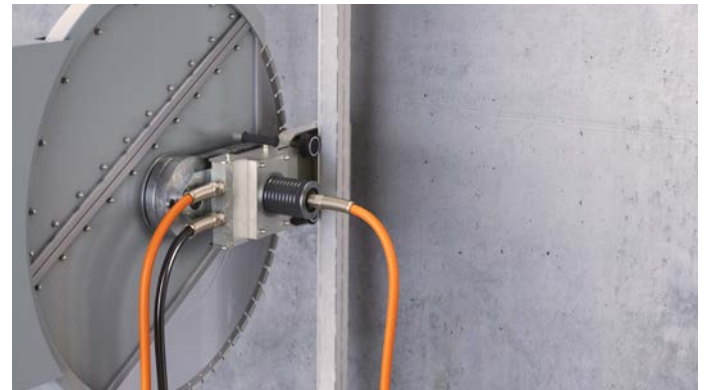
Betonsägemaschine / Concrete saw
