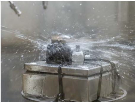
Dichtheitsprüfung / Sealing test
